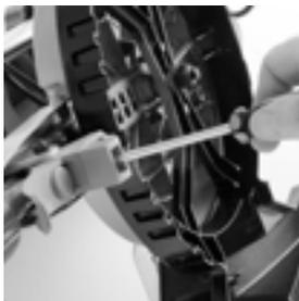
ターンテーブル45°角度設定の際に接触しないように、角度調整レバー下部ブロックを取り外して保管しておきます。
