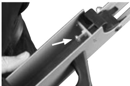
調整するには、まずロックナットをゆるめます。(調整完了後は確実にロックナットをしめてください。)
