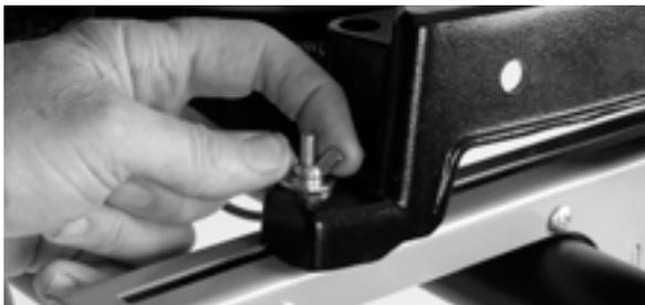
丸ノコのガイドフェンスが後方バーの中央部にそろう位置が最適です。必要に応じて位置を調整し、4箇所を確実に締め付けます。
