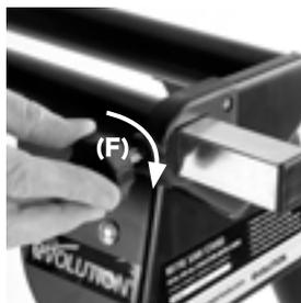
**調整ノブ(長)(F)**を適度にねじ込みます。※ 切断作業時には、部材が最も安定する位置にアーム長を調整します。
