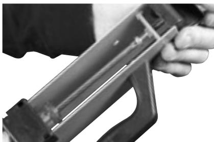
クランプ圧を上げるにはネジを右に、クランプ圧を下げるにはネジ左に回します。
