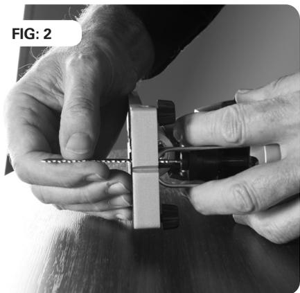
Tirer sur le manchon du mandrin de serrage à l'aide de votre doigt et du pouce d'une main. Insérez entièrement la lame dans le mandrin en veillant à ce que les dents de la lame soient orientées vers l'avant.
